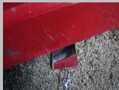
Onderzijde voordeuren nooit voorzien van verfsysteem
